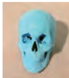
3Dプリンターで三次元造形された正常頭蓋モデル（実物の2/5サイズ）
