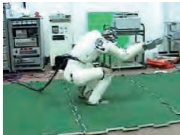
● 起き上がり全身運動ロボットの「起き上がる」様子
